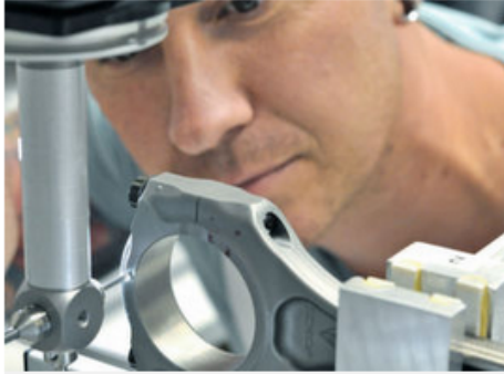
René Hautz, Mitarbeiter in der technischen Qualitätssicherung bei Pankl, bei der Endkontrolle eines Pleuels für einen Rennmotor. Das Lager an der Kurbelwelle wird mit einem Diamanttaster von Zeiss 3D Automation vermessen. (Bild: Zeiss)
