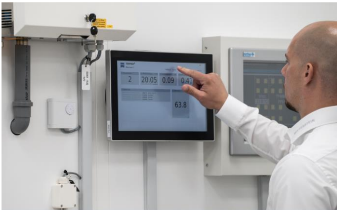
Alles im Blick: Die Konsole gibt Gravera eine Übersicht über die Temperaturwerte und die Messraumklasse
