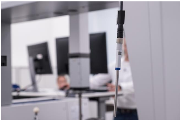
Sensoren des ZEISS TEMP PAR messen die Temperatur des Messraums
