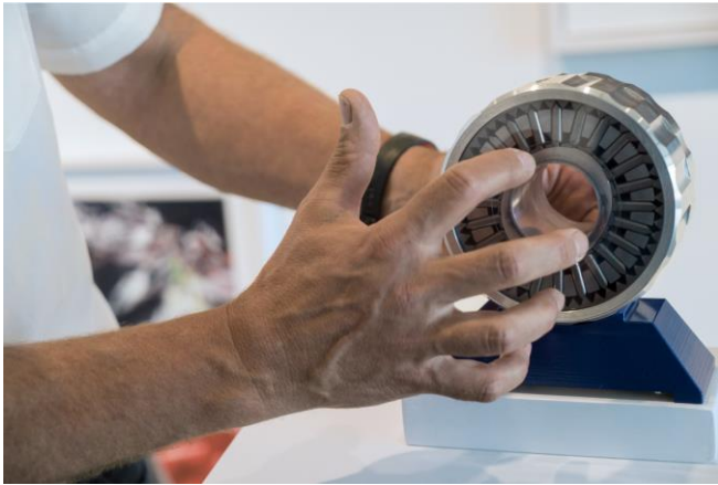
Galaxie von Wittenstein: Innovative Getriebegattung mit 48 dynamisierten Einzelzähnen
